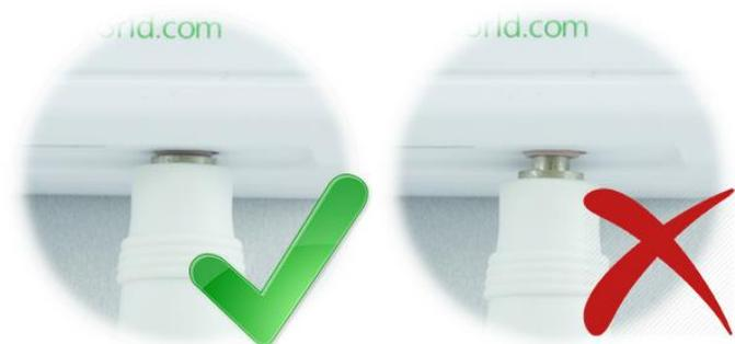
**HINWEIS!** Stellen Sie sicher, dass der Sensor richtig in die rote 3,5mm Klinkenbuchse eingesteckt ist. Die Verbindung ist eng und Sie müssen sicherstellen, dass es keinen Spalt zwischen dem Stecker und der Klinkenbuchse gibt!
