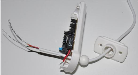
Machen Sie Schlaufen und schneiden Sie den Rest des verzinnten Kabels ab.
